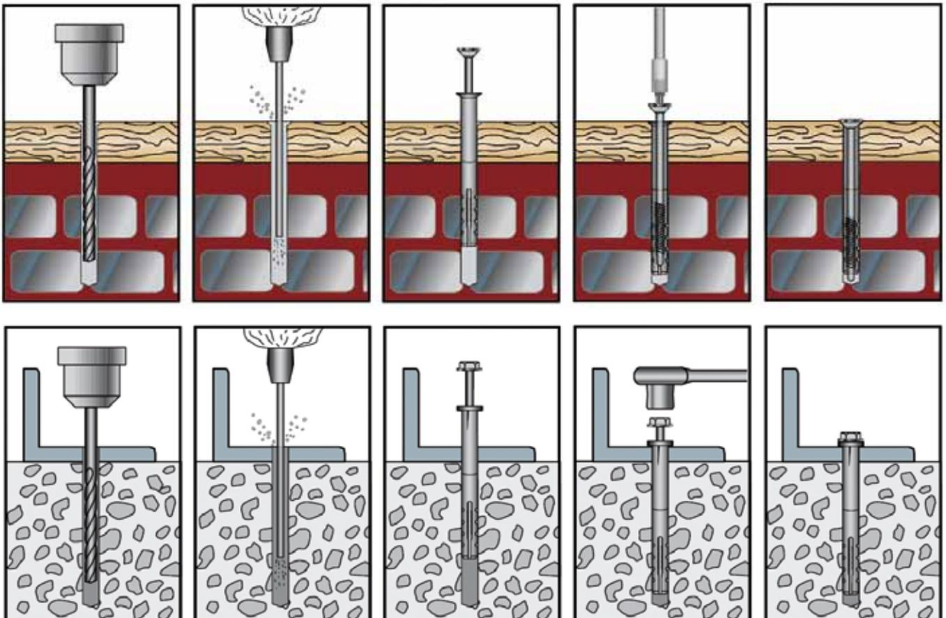
**Unser Tipp:** Bei Loch- und Hohlblocksteinen im Drehgang bohren. Ohne Schlagfunktion! Entfernen Sie das Bohrmehl aus dem Bohrloch!
