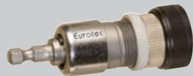
Der Screw Stop ist die ideale Lösung, um Schrauben gleichmäßig tief ins Holz zu versenken. Ihre Terrasse erhält somit ein ansprechendes, gleichmäßiges Oberflächenbild. Mit dem stufenlos verstellbaren Tiefenanschlag stellen Sie einfach die gewünschte Senktiefe ein. Wenn diese beim Einschrauben erreicht ist, kuppelt sich der Antrieb aus und die Schraube stoppt.
