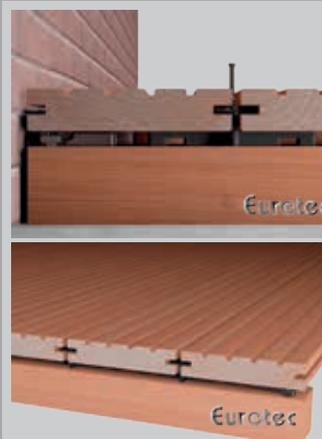
Ausrichten und Fixieren der nächsten Dielen, mit dem **T-Stick** die Verschraubung vornehmen bis alle Dielen befestigt sind.
