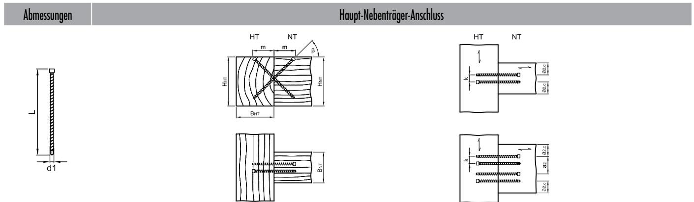
$a_2 = \text{min. } 50 \text{ mm}, a_{2,c} = \text{min. } 30 \text{ mm}, k = \text{min. } 15 \text{ mm}$
