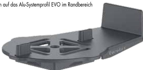
Um ein Verrutschen einzelner Steinplatten zu vermeiden, sind die Stone-Edge-Clips im Randbereich durch Schrauben an der Aluminium-Unterkonstruktion zu fixieren. Die Clips verfügen zu diesem Zweck über einen Schraubkanal in der Mitte.
