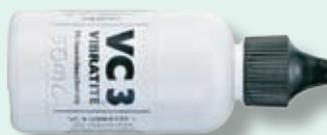
Gewindesicherung VC3 ist ein lackähnlicher Überzug, welcher zwei getrennte, mikroverkapselte Komponenten enthält. Die Eigenschaften als Sicherungselement werden erst beim Einschrauben aktiv. Die Verbindung ist vibrationsfest gesichert. Damit ist die Sicherheit gegen selbstständiges Lösen gewährleistet.
