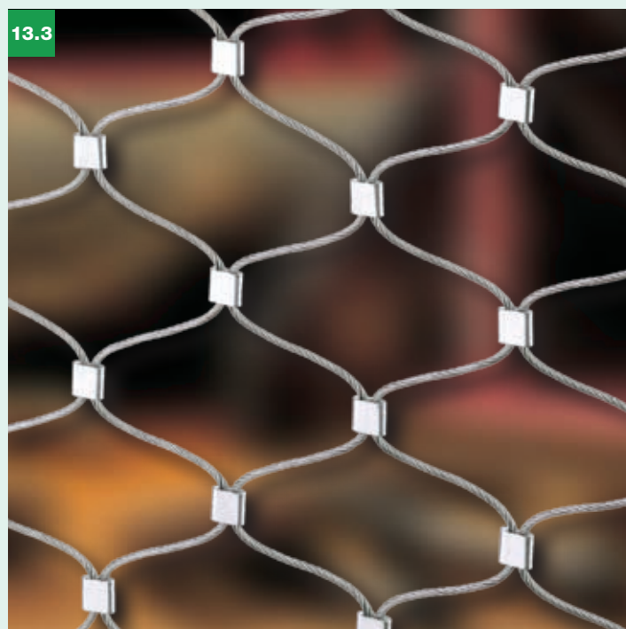
Webnet avec angle de maille trop obtus: les câbles tendus à l'horizontal exercent une forte pression sur la douille (charge de rupture).
