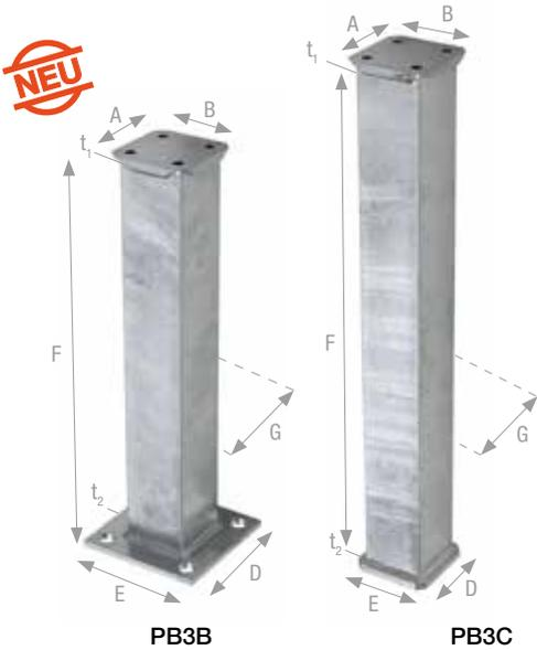
PB3B und PB3C Stützenfüße erfüllen die Anforderungen an den baulichen Holzschutz gemäß DIN 68800 und den Fachregeln des Zimmererhandwerks. Aufgrund der großen Rohrlängen werden die erforderlichen 300 mm freier Abstand zur Bodenoberfläche, auch bei hohen Stützlasten, sicher eingehalten.
