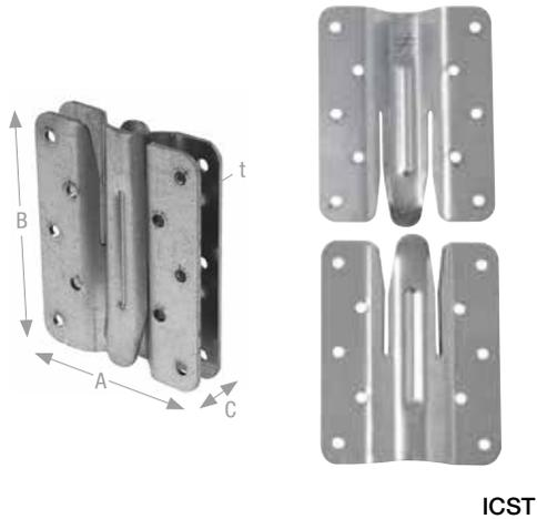
ICST Elementverbinder bestehen aus zwei gleichen Teilen, die an den Stoßflächen der zu verbindenden Elemente angeschraubt bzw. angenagelt werden. Es ist an nur einem Element eine Aussparung von 15 mm Tiefe erforderlich, bei einer 15 mm dicken Beplankung ist lediglich ein Ausschnitt an entsprechender Stelle nötig.
