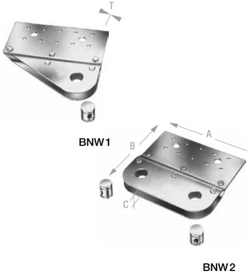
BNW Windverbandanschlüsse ermöglichen einen flexiblen Anschluss von Stahldiagonalen z. B. in einer Holzhallenkonstruktion. Die Verbinders werden in die Dachträger eingeschlitzt und mit Stabdübeln angeschlossen.
