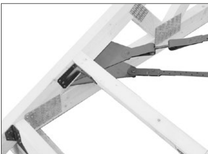
Detail am Traufpunkt: Bandanschluss BNG25 mit Kopplungsverbinder BNKK25 auf der Oberseite des Untergurtes und dem Spanngerät BNSP25 auf der Unterseite des Obergurtes. Die Wechselbalken dienen als Druckhölzer.
